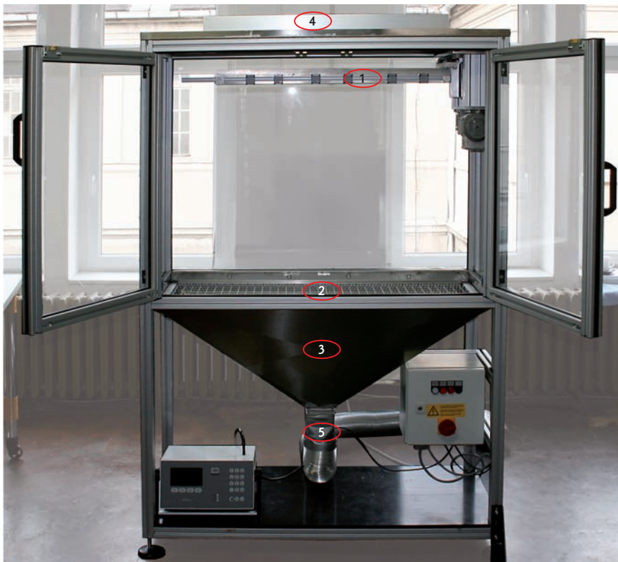
Abb. 18: Messeinheit gesamt. 1) Halteschiene Karten, 2) Abdeckgitter, 3) Trichter, 4) Feinstfilter Ansaugluft, 5) Messeinheit Partikel.
