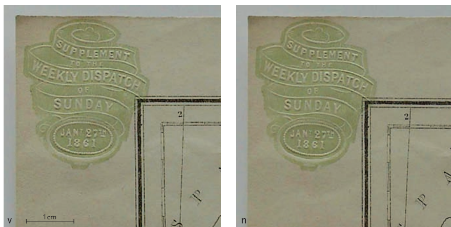
Abb. 16: Prägestempel der Karte Nr. 547$11133960X vor (v) und nach (n) dem Durchlauf durch die Reinigungsanlage.
