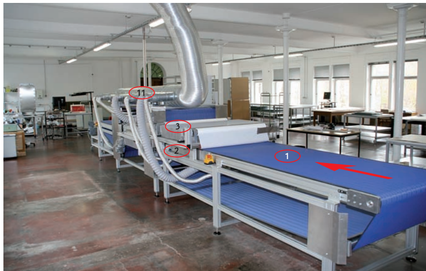
Abb. 7c: Kartenreinigungsanlage Gothana. 1) Laufband, Vorlauf, 2) Ansaugeneinheit 1, 3) Reinigungsmodul 1, 11) Absaugsystem.
