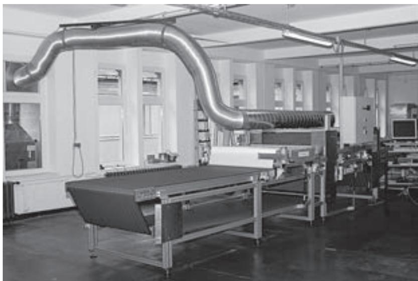
Abb. 2: Kartenreinigungsanlage
